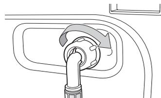
6. Включите подачу воды и убедитесь, что нет протечки воды из клапана подачи воды, крана или адаптера. Если есть протечка воды, повторите предыдущие действия.
